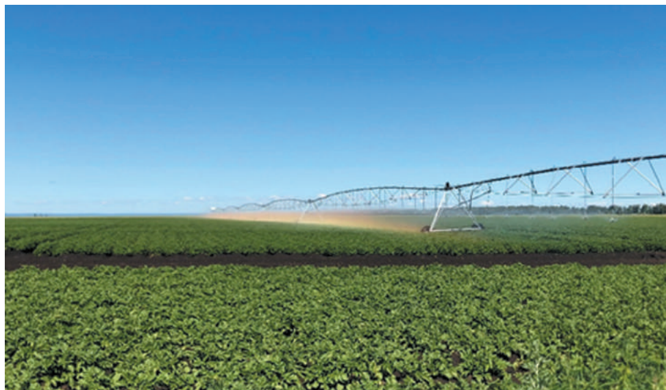
Полив посадок установкой BAUER «Centerliner CLE»
